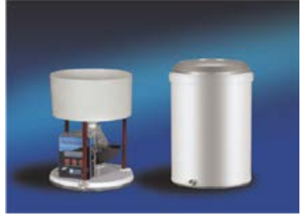
Şekil: 1 Plüviyograf cihazının içi ve dışının görünümü
